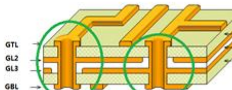
spojnice u TH tehnologiji
