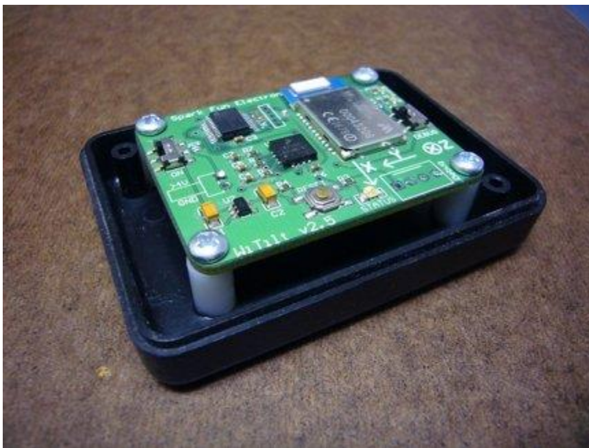
5.30. Štampana ploča montirana preko rupa na telo kutije.
