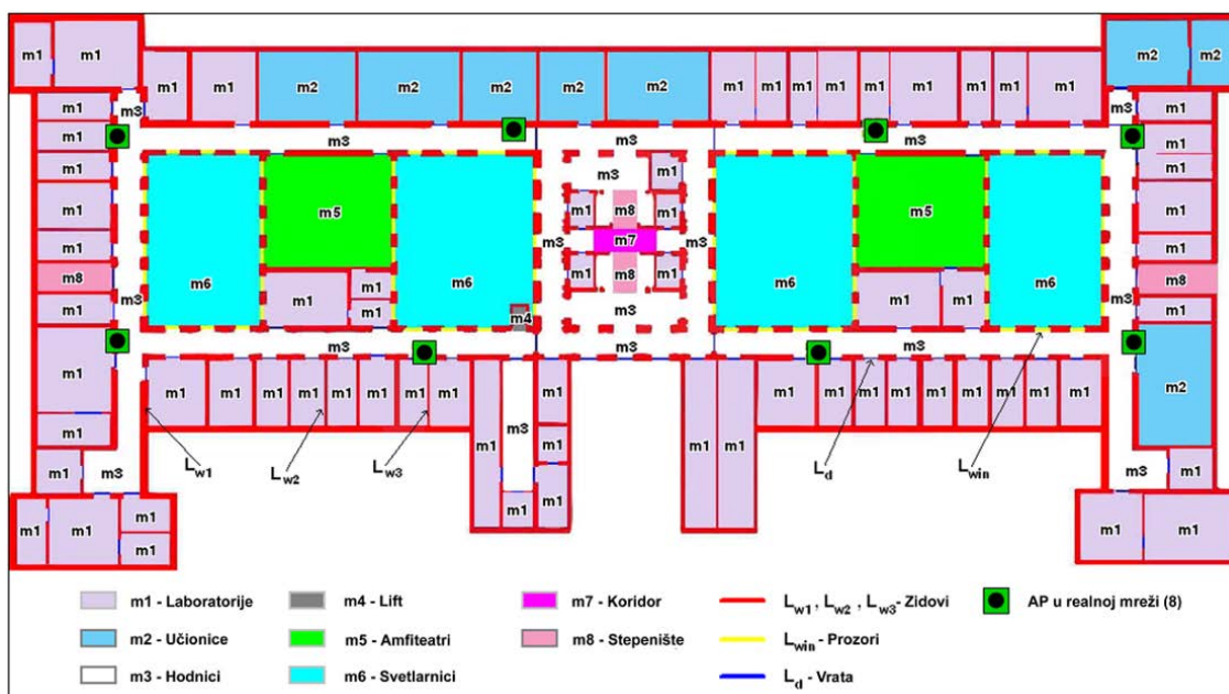
Slika 5.1. Plan prizemlja u zgradi Elektrotehničkog fakulteta.
